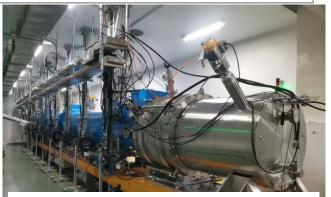
FPC on 1.3 GHz Cryomodule
